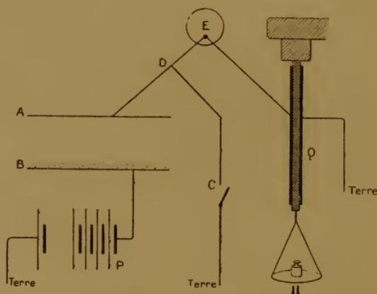
employée consiste à mesurer la conductibilité acquise par l'air sous l'action des substances radioactives; cette méthode a l'avantage d'être rapide et de fournir des nombres que l'on peut comparer entre eux. L'appareil que j'ai employé à cet effet se compose essentiellement d'un condensateur à plateaux AB (fig. 1). La substance active finement pulvérisée est étalée sur le plateau B; elle rend
